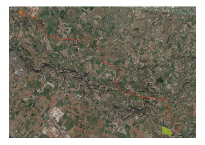
Nell'immagine satellitare di cui sopra, l'area occupata dall' impianto fotovoltaico è evidenziata in verde, mentre è indicato con una linea rossa l'elettrodotto, ovvero la linea elettrica in cavo alla tensione nominale di esercizio di 36 kV (MT) che collega in antenna su un futuro ampliamento della Stazione Elettrica (SE) (in colore arancione) della RTN a 36/132 kV denominata "Lonato" come indicato nella Soluzione Tecnica Minima Generale.
