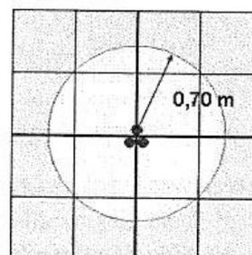
Fascia di rispetto ( $B > 3 \text{ microT}$ ) per cavo interrato MT ad elica visibile (passo d'elica 3 m) – sez. 185 mm<sup>2</sup> – In 324 A
