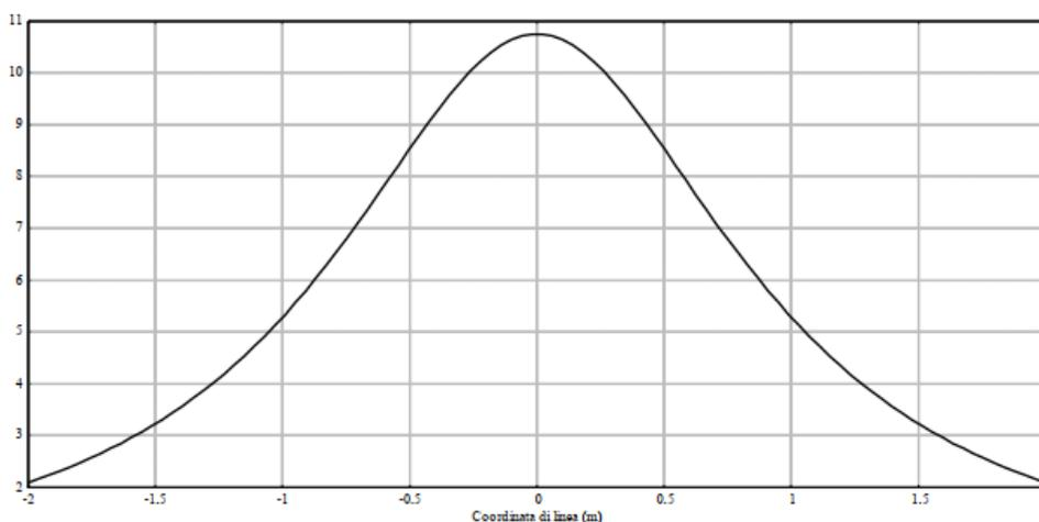
Si denota, come in corrispondenza dell'asse del cavo (x: 0 m), il valore si attesta attorno a 10,5 µT, per poi decrescere simmetricamente su ambo i lati, rimanendo sotto il valore di 3 µT nella fascia compresa da -1,6 e 1,6 m rispetto ad asse terna di cavi.
