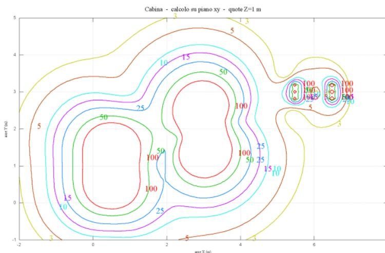
Si nota, come all'esterno del perimetro della cabina (avente lunghezza 6 m da quota x:0 a x: 6 e larghezza 2,5 m da quota y:0 a y: 2,5), i valori di concentrazione decrescono da 50  $\mu\text{T}$  fino a 3  $\mu\text{T}$  nel giro di 2,5-3 m da filo esterno cabina.
