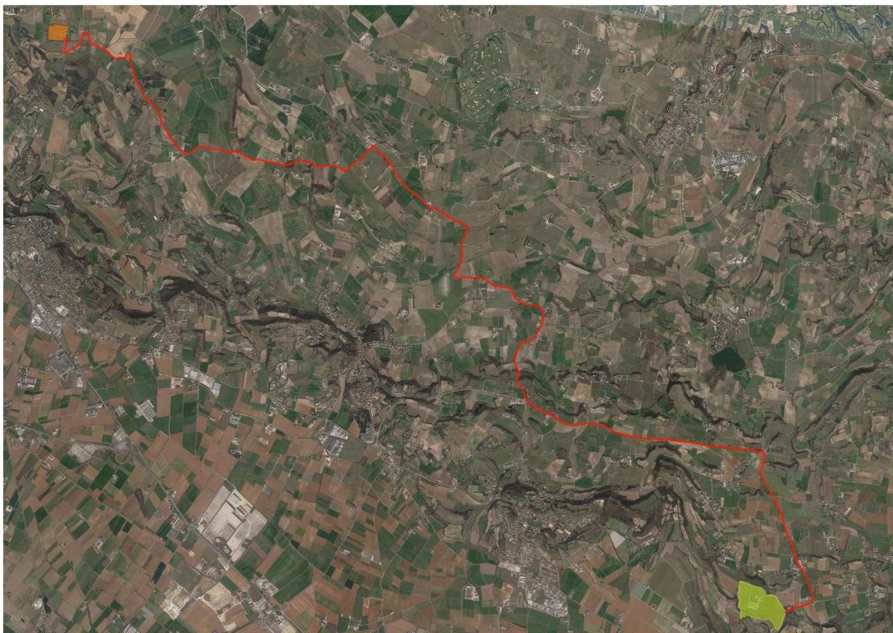
Nell'immagine satellitare di cui sopra, l'area occupata dall'impianto fotovoltaico è evidenziata in verde, mentre è indicato con una linea rossa l'elettrodotto collegato in antenna a 36 kV su un futuro ampliamento della Stazione Elettrica (SE) (in colore arancione) della RTN a 36/132 kV denominata "Lonato" come indicato nella Soluzione Tecnica Minima Generale.
