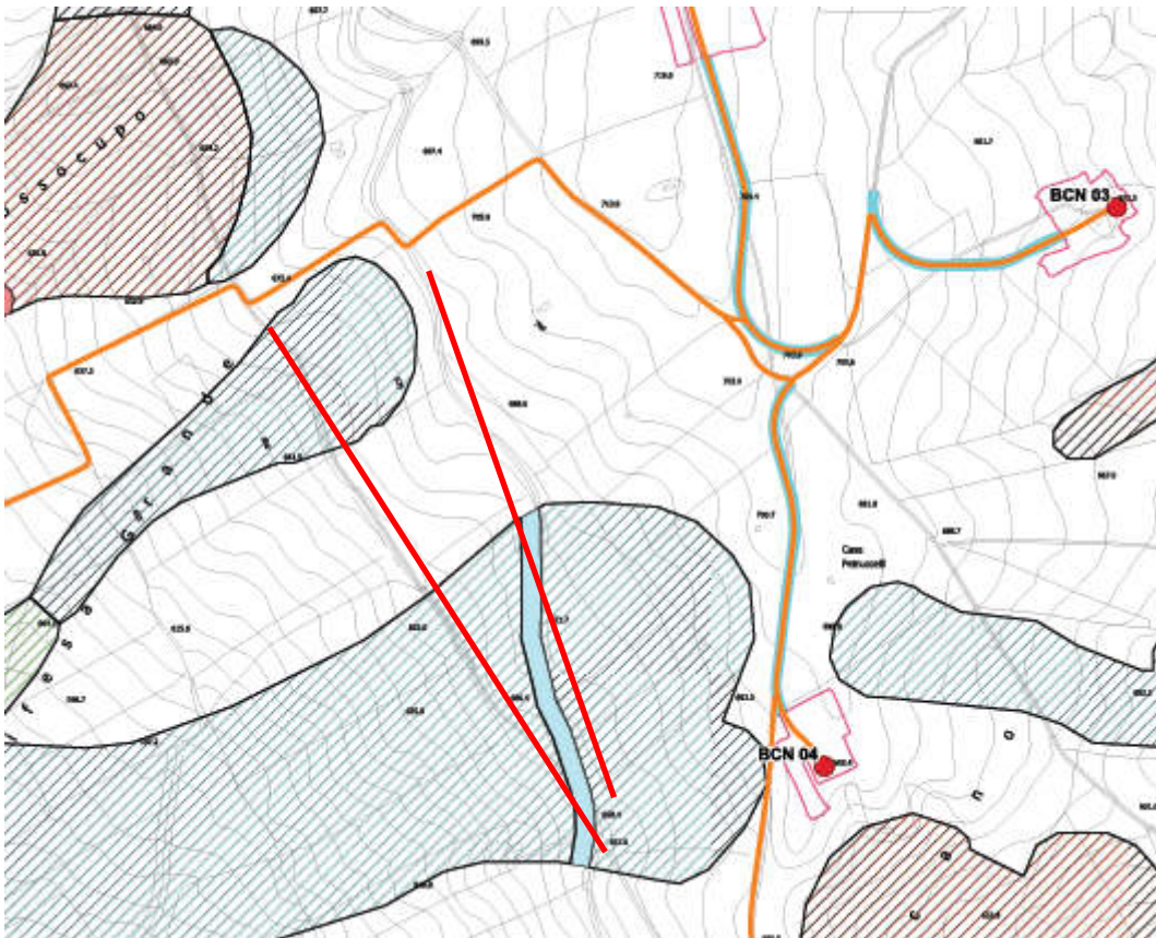
Figura 39- In rosso le alternative del tracciato cavidotto individuate ma non prese in considerazione per interferenza con aree a pericolosità da frana.
