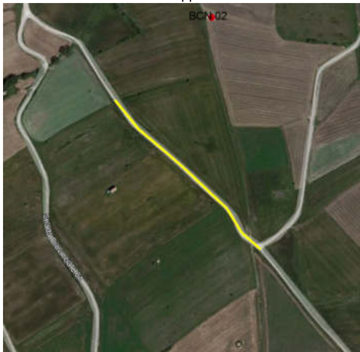
Figura 36- Tratto interferenza cavo MT con Tratturello Castelfranco-Volturara.
