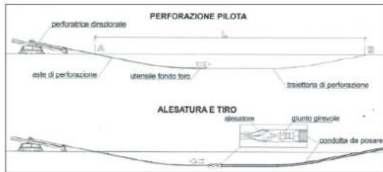
Figura 24: Schematico di trivellazione orizzontale controllata.
