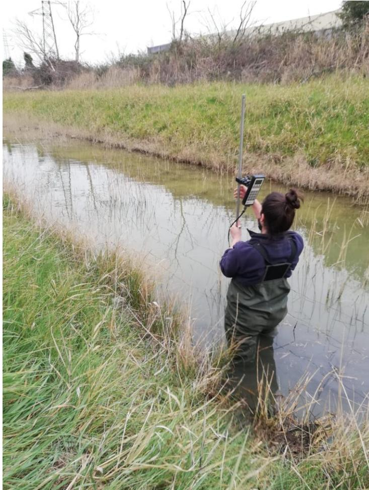
**Figura 8 - Realizzazione delle misure di portata**
