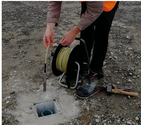
Figura 10 Utilizzo del freatimetro per la misura del livello piezometrico
