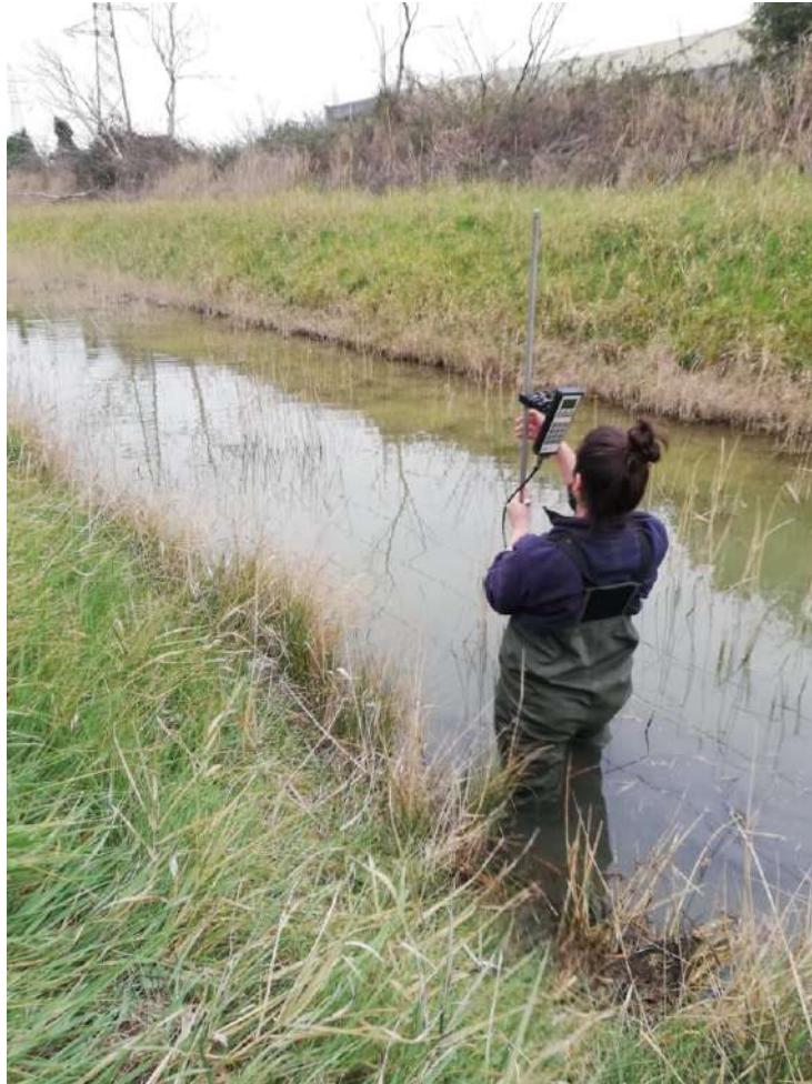
Figura 8 - Realizzazione delle misure di portata
