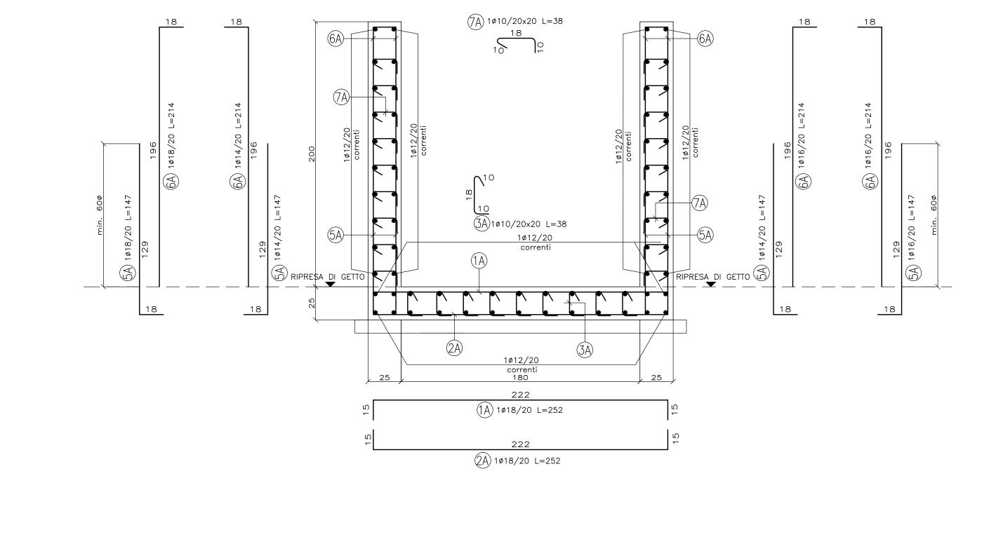
ARMATURA — SEZIONE C—C
