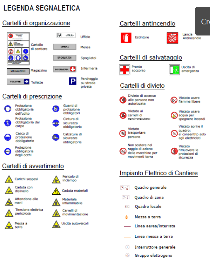
Figura 71- Segnaletica di cantiere
