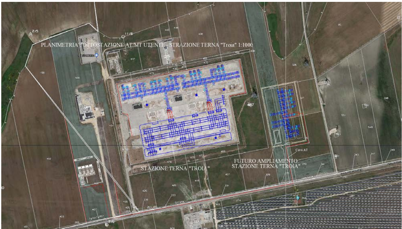
Figura 3- Ampliamento SE e ubicazione stazione elevazione AT/MT
