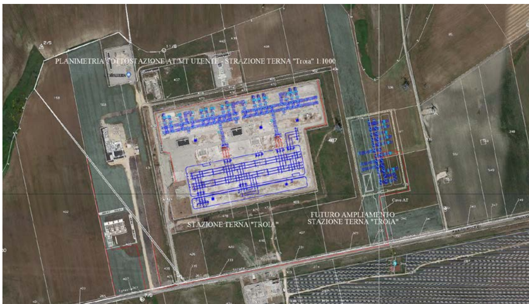
Figura 10- Ampliamento SE e ubicazione stazione elevazione AT/MT
