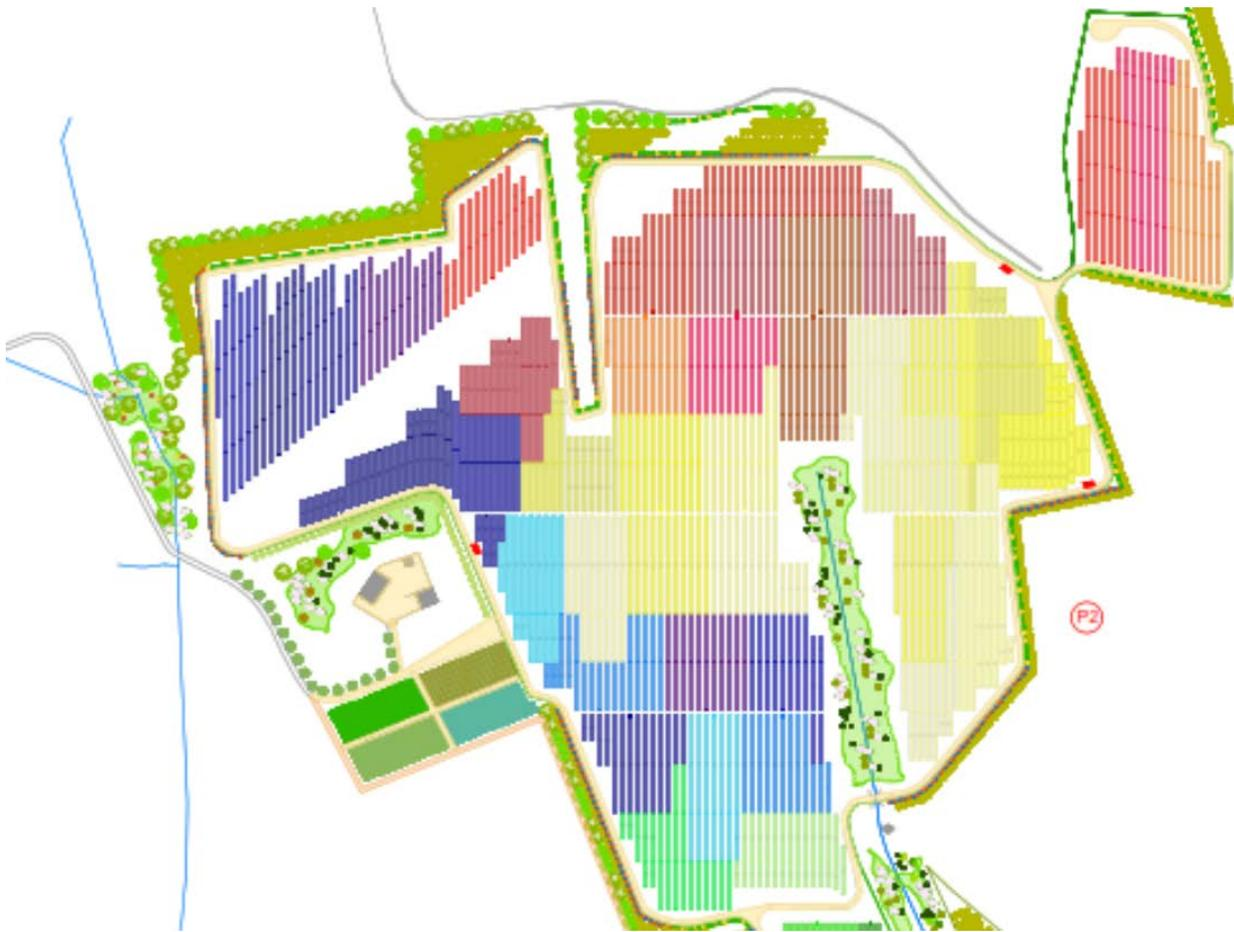
Fig. 1- Particolare schema di suddivisione sottocampi area superiore impianto
