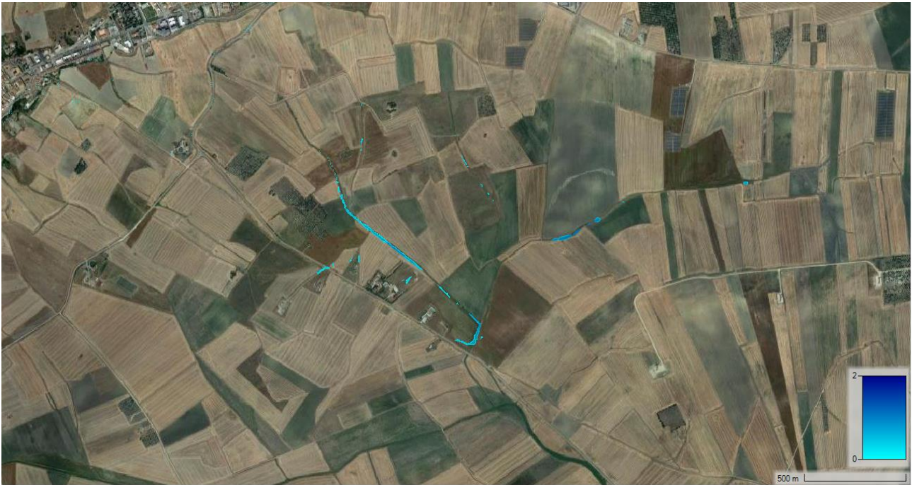
Figura 30 - Mappatura delle aree a deflusso critico con Tempo di Ritorno a 30 anni
