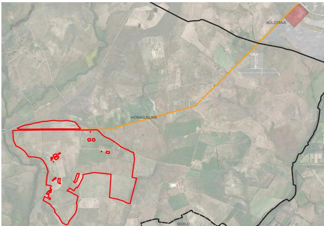
Trattandosi di posa del cavo su strada pubblica comunale asfaltata, si prevede la posa del cavo in trincea con profondità del cavo minimo a 100 centimetri rispetto al manto stradale.
