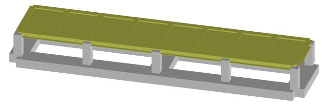
Gli elementi inseriti non alterano il comportamento degli elementi strutturali oggetto di progettazione, sono stati modellati con elementi di infinita rigidezza e peso nullo.
