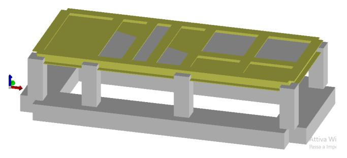
Gli elementi inseriti non alterano il comportamento degli elementi strutturali oggetto di progettazione, sono stati modellati con elementi di infinita rigidezza e peso nullo.
