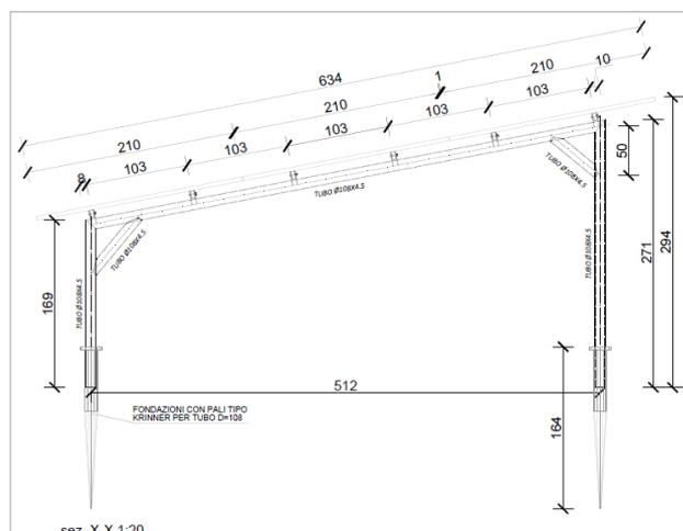
Tali parametri permettono di inquadrare la struttura base come un intervento privo di rilevanza per la pubblica incolumità ai fini sismici secondo la DGR 22272/2016 intervento A.4.7 "Strutture di sostegno (quali pali, portali, etc.) per pannelli solari e fotovoltaici di altezza dal livello del terreno  $\leq 3$  m e superficie  $\leq 30$  m<sup>2</sup>.
