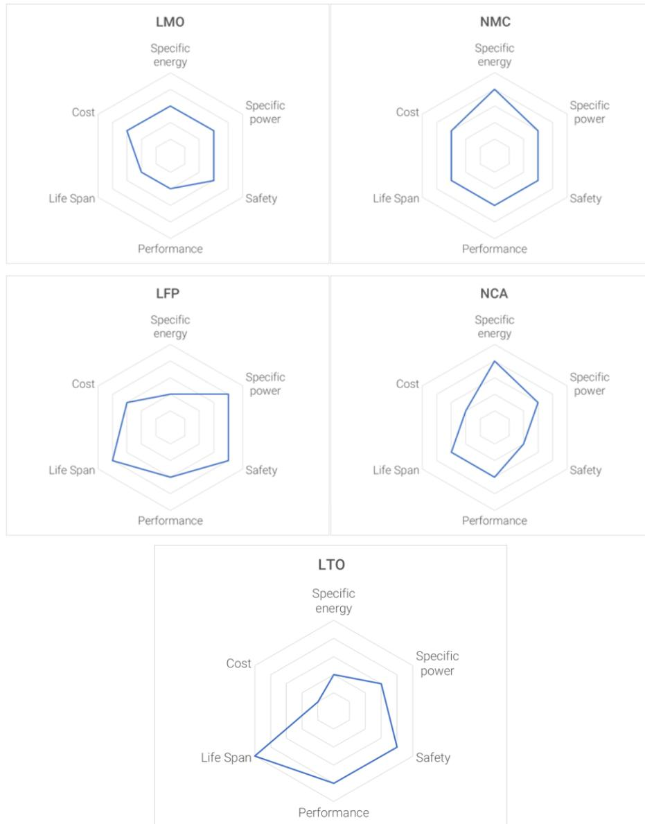
**Fig. 27 - Caratteristiche tecnologie litio**
