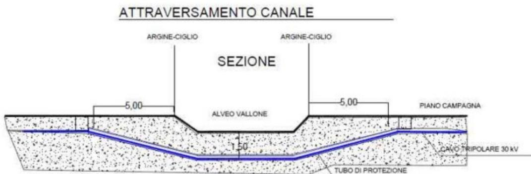
**Fig. 25 - Attraversamento canale – cavidotto MT**
