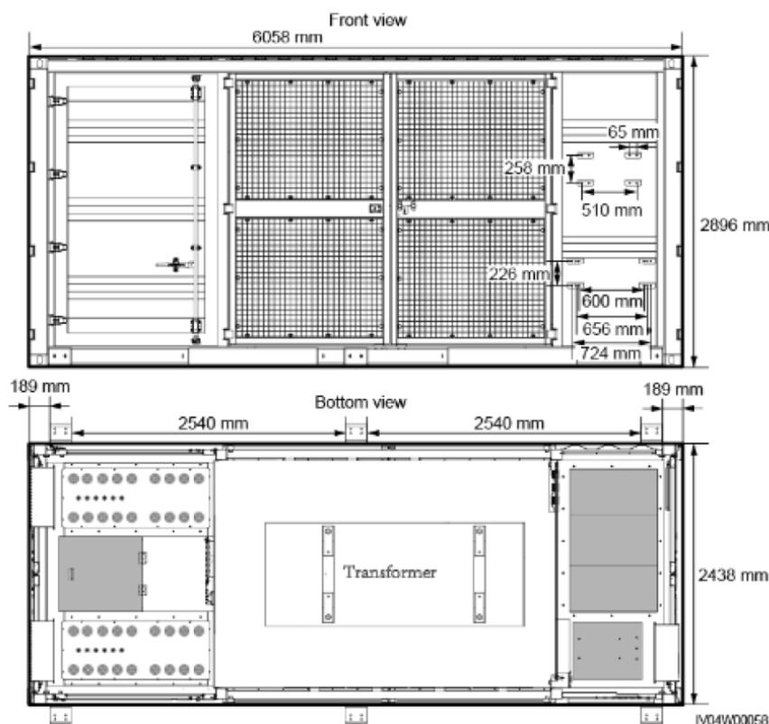
**Fig. 4 - Ingombri cabine di trasformazione MT/BT**
