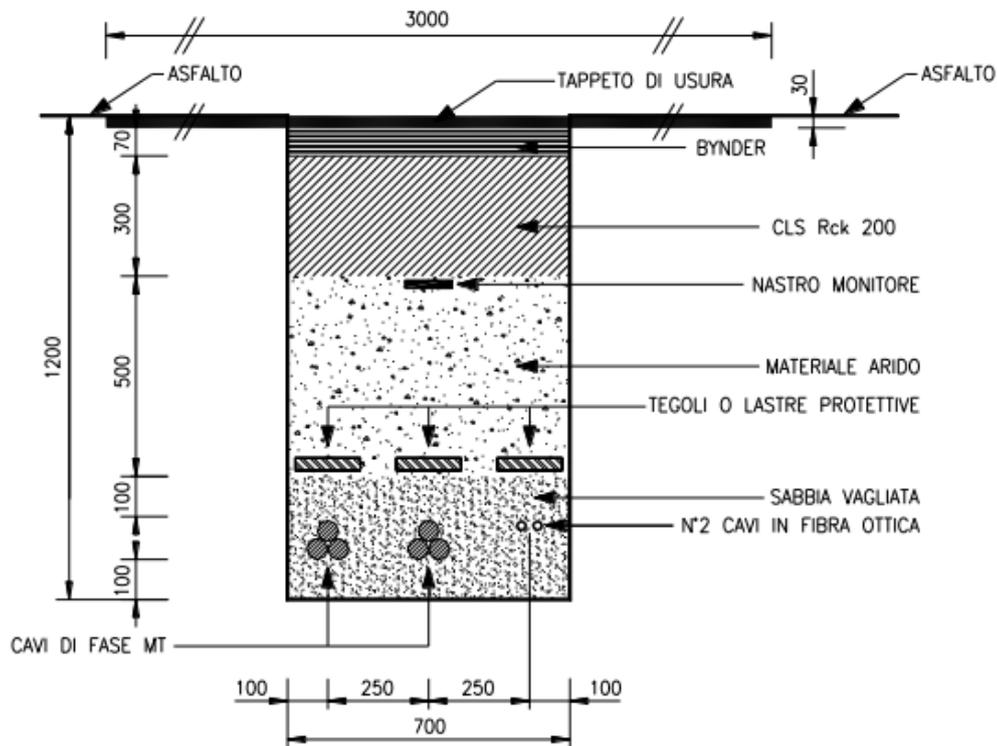
Fig.7 - Sezione tipica di posa della linea in cavo su sede stradale
