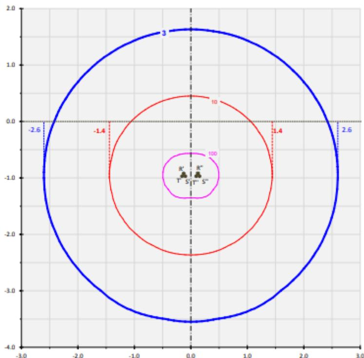
Fig. 10 - curve di equivello per il campo magnetico della linea MT interrata in cavo (due terne)
