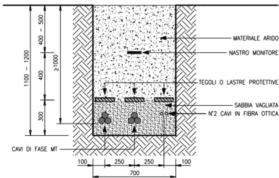
**Fig.6 - Sezione tipica di posa della linea in cavo**
