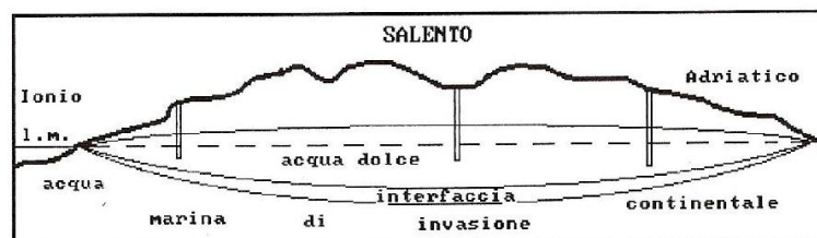
FIG 6 - Sezione idrogeologica schematica della Penisola Salentina
