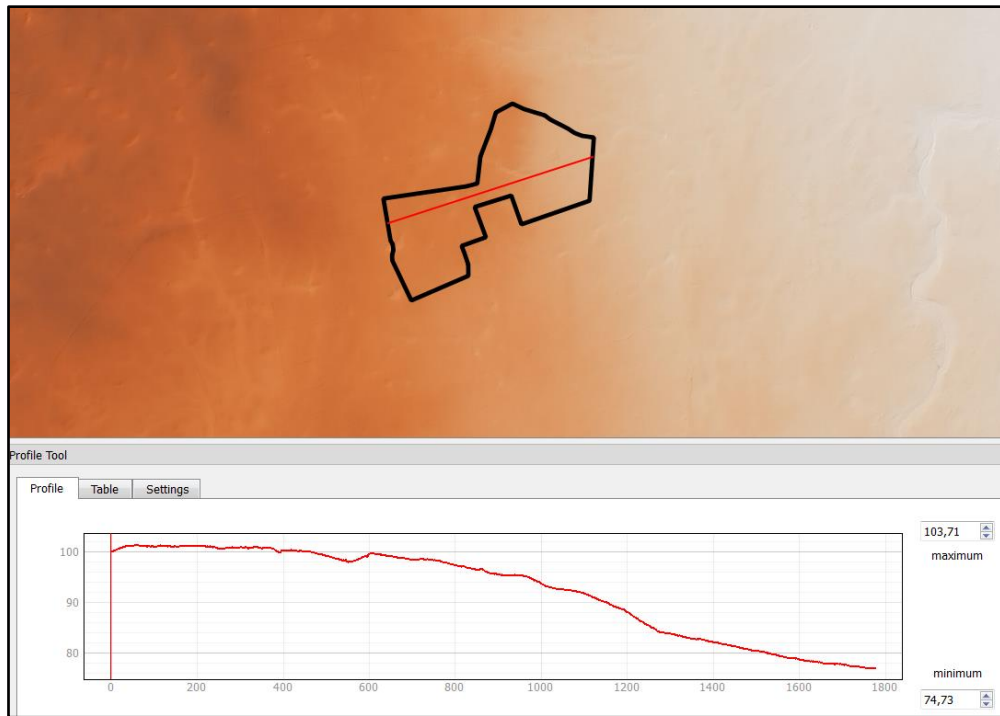
FIG 6A – Andamento topografico del terreno su sezione longitudinale nell'area di progetto
