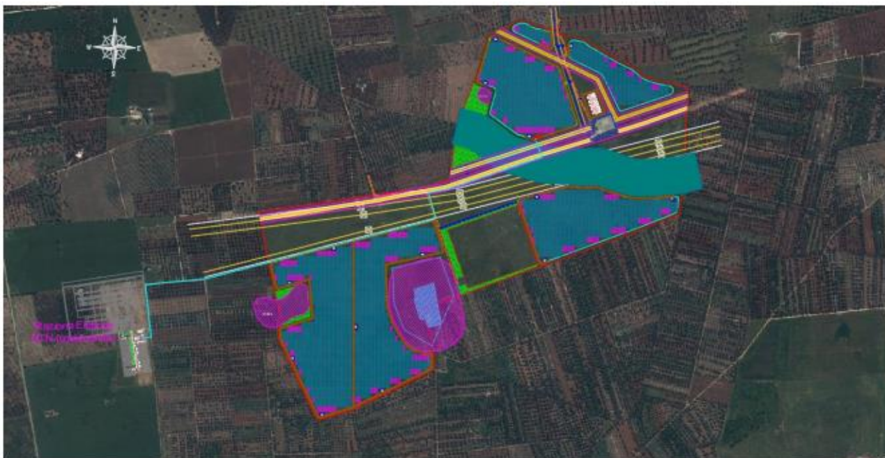
Tracciato di collegamento tra l'impianto "LOTTO 9" e la futura SE RTN 380/150 kV di Latiano
