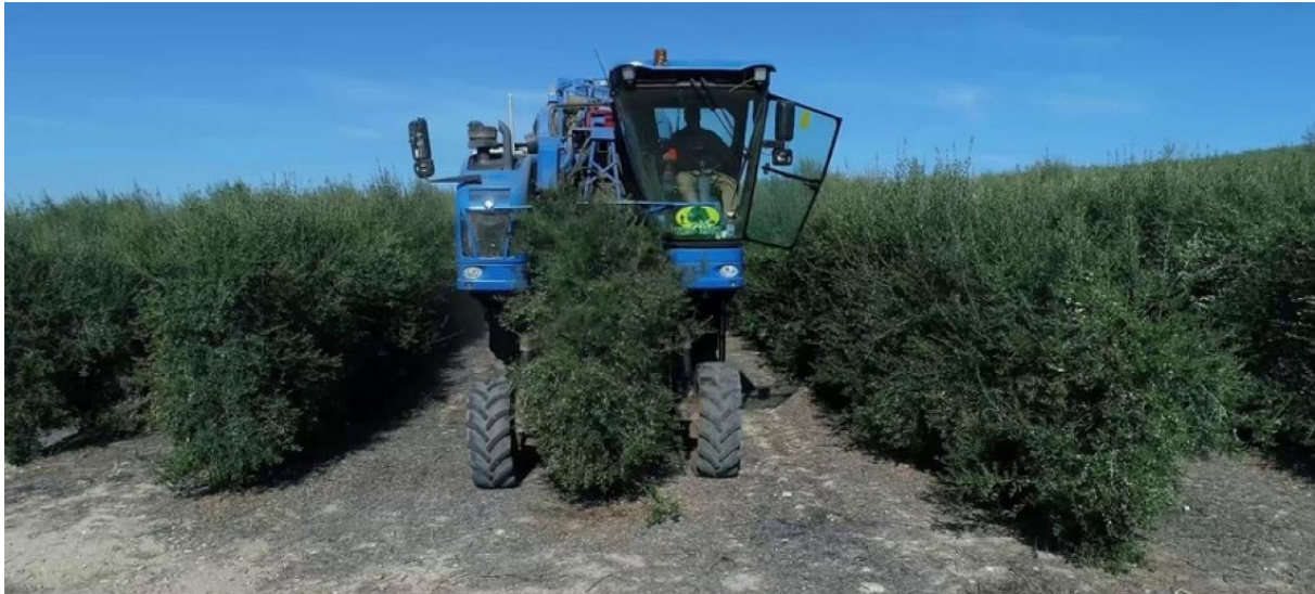
Foto 7 - Macchina scavallatrice durante le operazioni di raccolta in oliveto superintensivo a siepone
