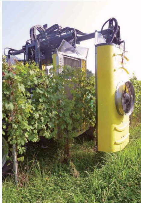
Foto 6 - pompa irroratrice a polverizzazione pneumatica con diffusore anti-deriva
