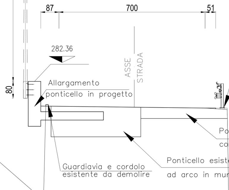
Posa in opera barriera guardavia tipo H3 con vincolo a piastra su cordolo esistente previa demolizione guardavia esistente e parte sommitale cordolo e ricostruzione dello stesso
