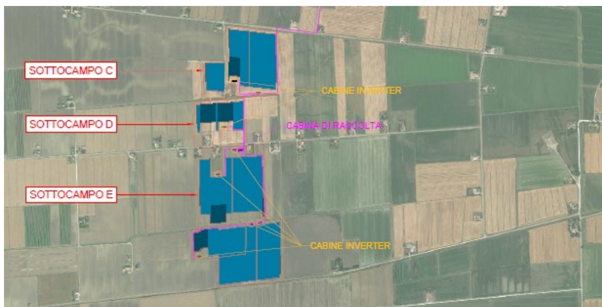
Figura 4-3 Layout di impianto – sottocampi C/D/E
