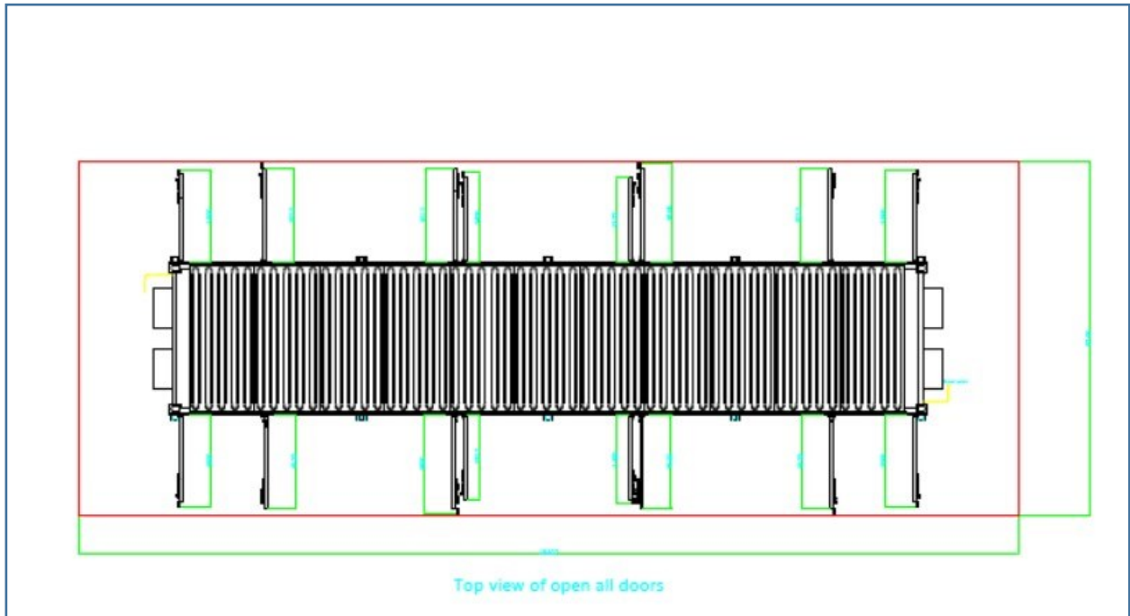
FIGURA 22: CABINATO PER STORAGE (BESS) VISTA DALL'ALTO
