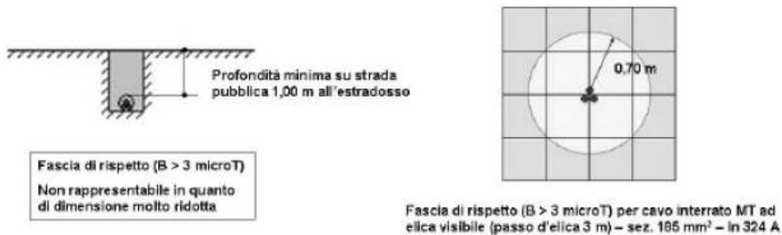
Figura 2: Curve di livello dell'induzione magnetica generata da cavi cordati ad elica – calcoli effettuati con il modello tridimensionale "Elico" della piattaforma "EMF Tools", che tiene conto del passo d'elica.
