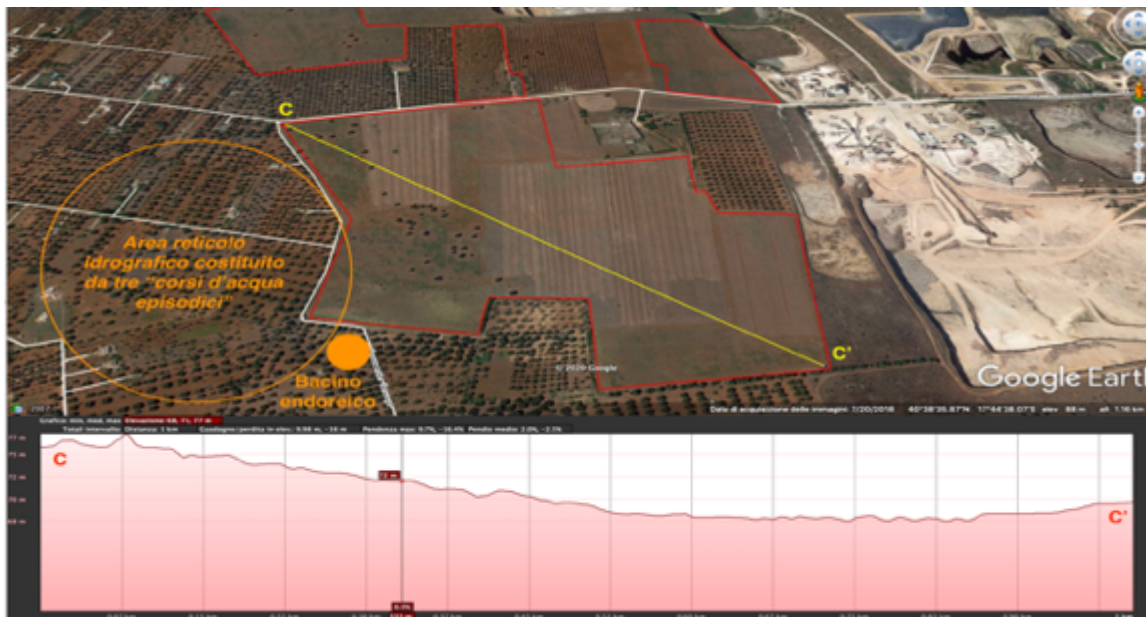
Tavola n. 21: Sezione C-C' trasversale del sotto campo meridionale.
