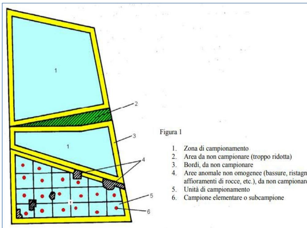
Fig. 11: Schema tipo per la definizione delle zone di campionamento. Fonte "Linee guida per il campionamento dei suoli e per l'elaborazione del piano di concimazione aziendale" Regione Sicilia
