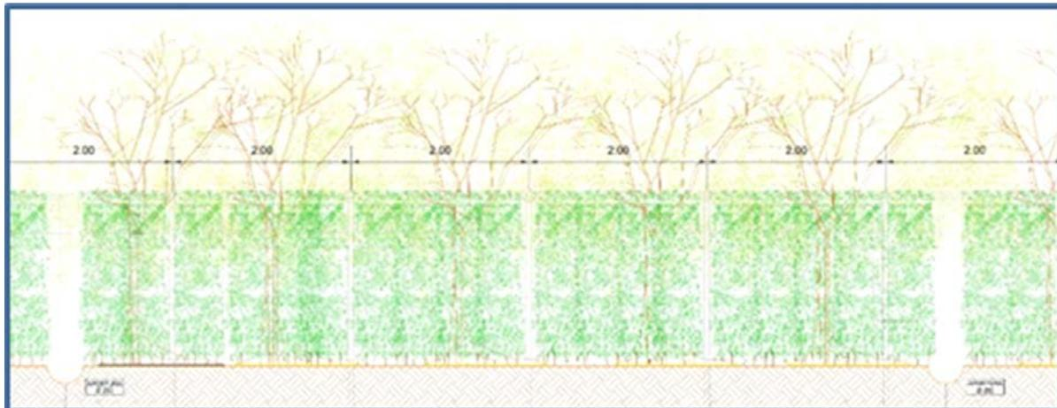
Fig. 28: particolare aperture per il passaggio della fauna in corrispondenza della recinzione perimetrale
