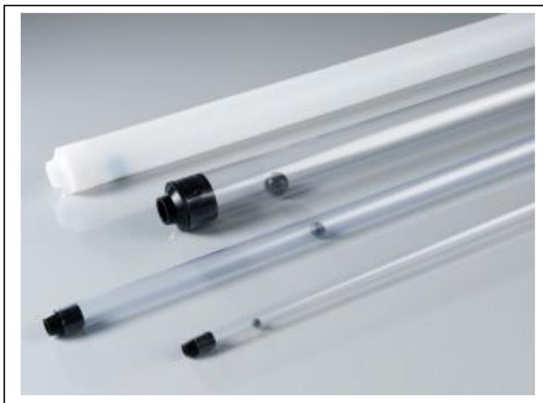
*Fig. 25: Bailers monouso per il prelievo di acque in foro*
