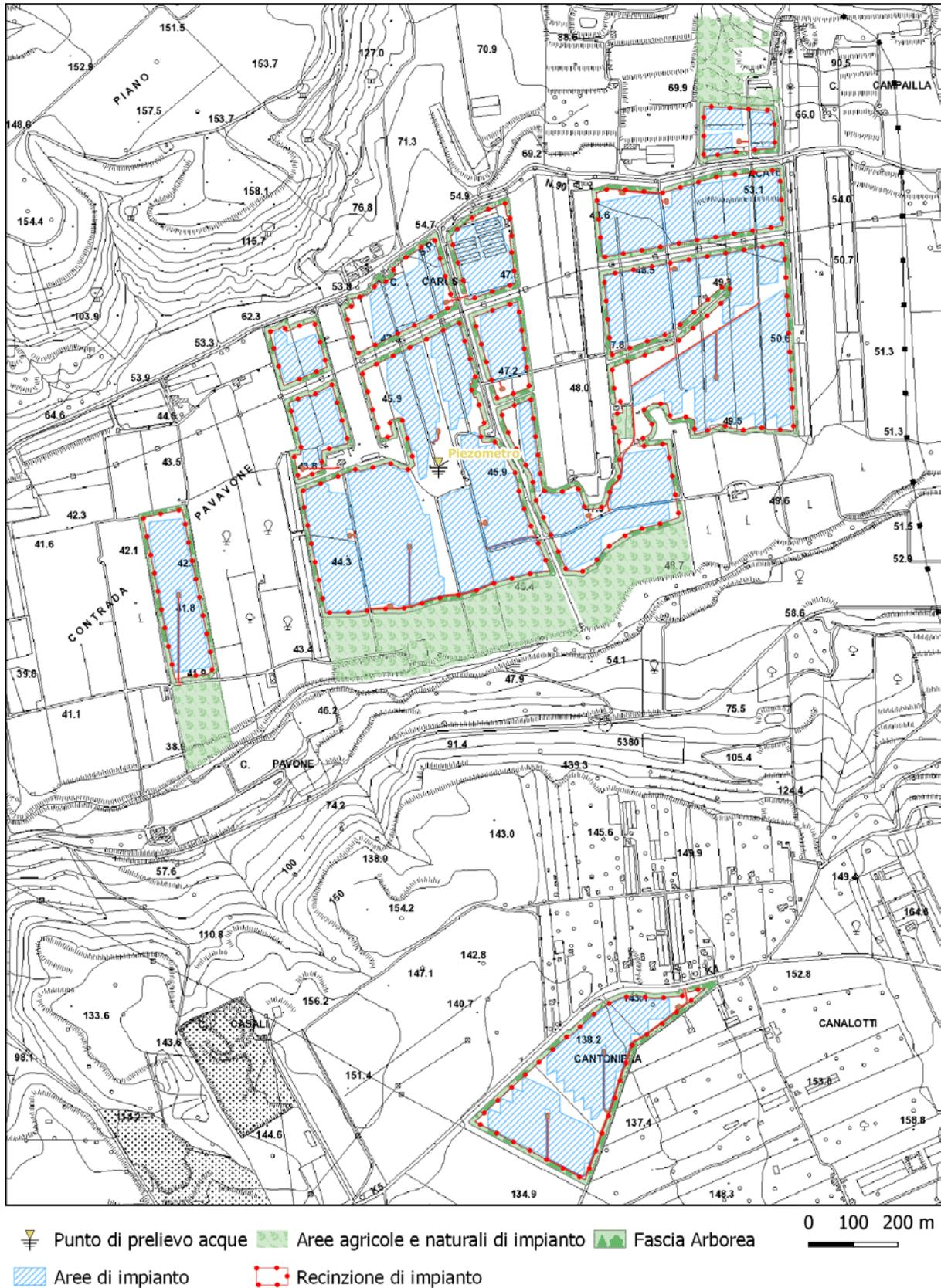
Fig. 25°- Mappa del possibile posizionamento del Piezometro per il monitoraggio della falda acquifera
