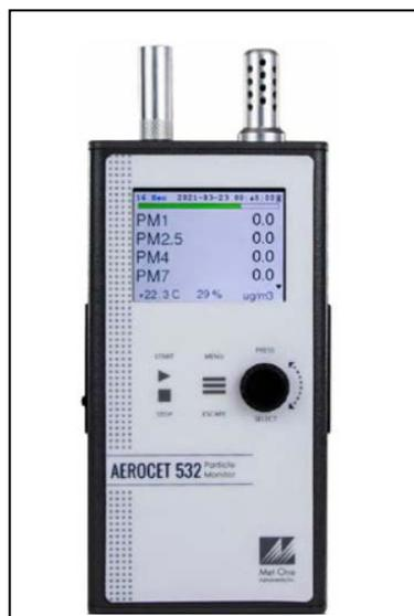
Fig. 07: Strumentazione per la misura del particolato in continuo.
