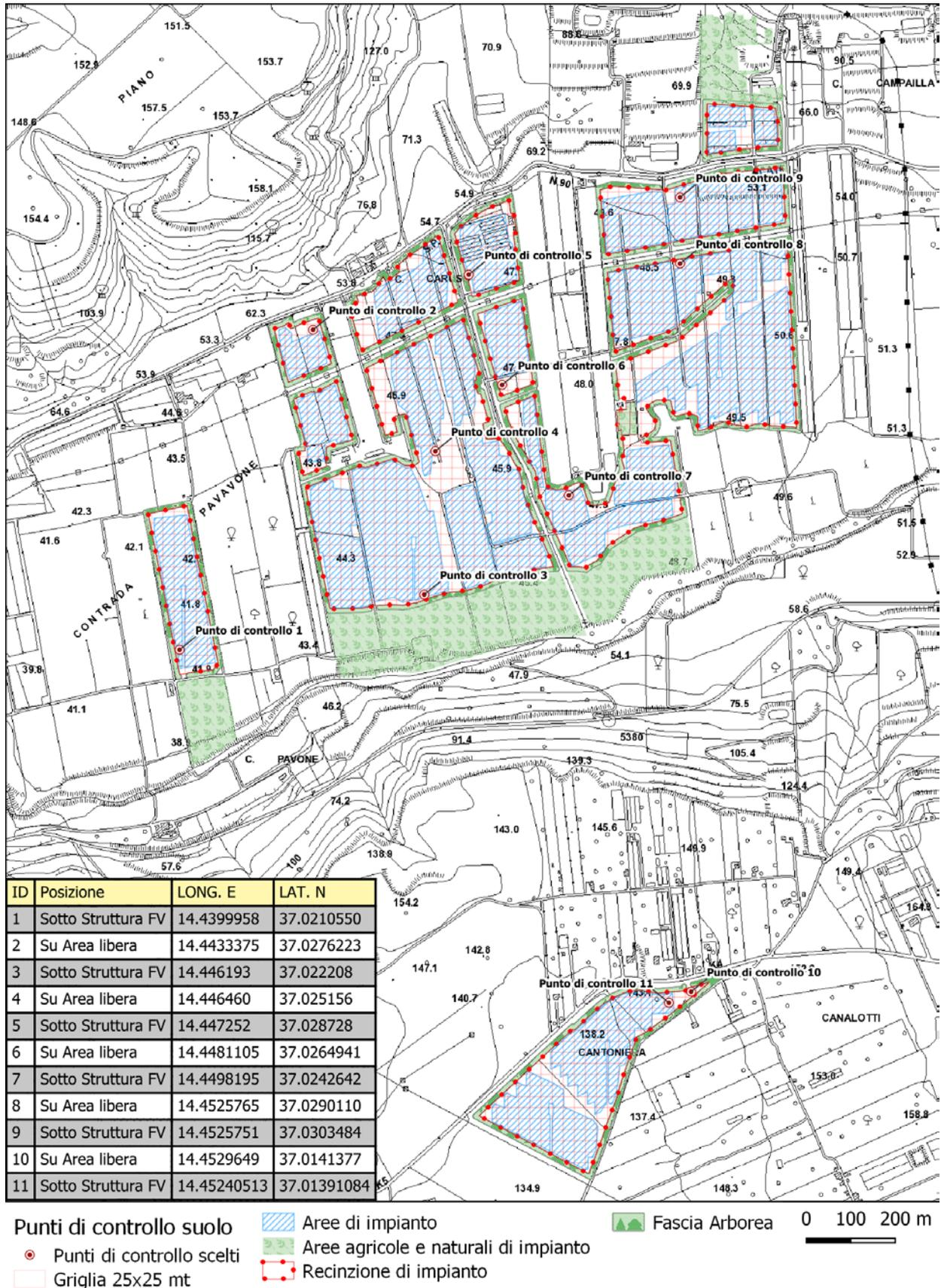
Fig. 16 c: Area Impianto con localizzazione punti campionamento finali
