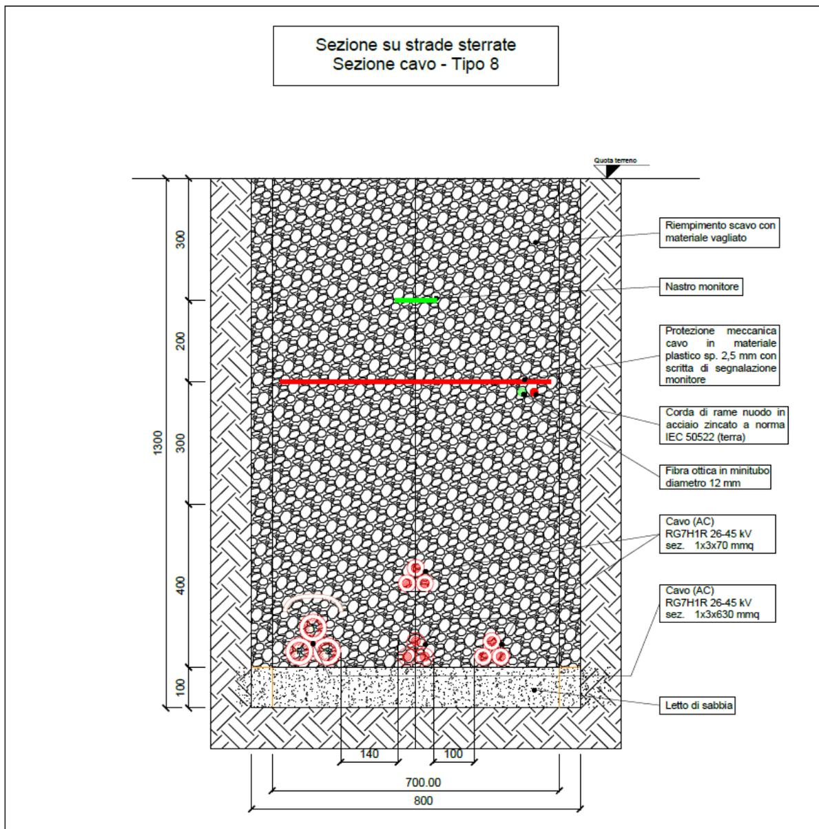
Fig. 6.5.6-4 Tipico sezione di posa con quattro cavidotti
