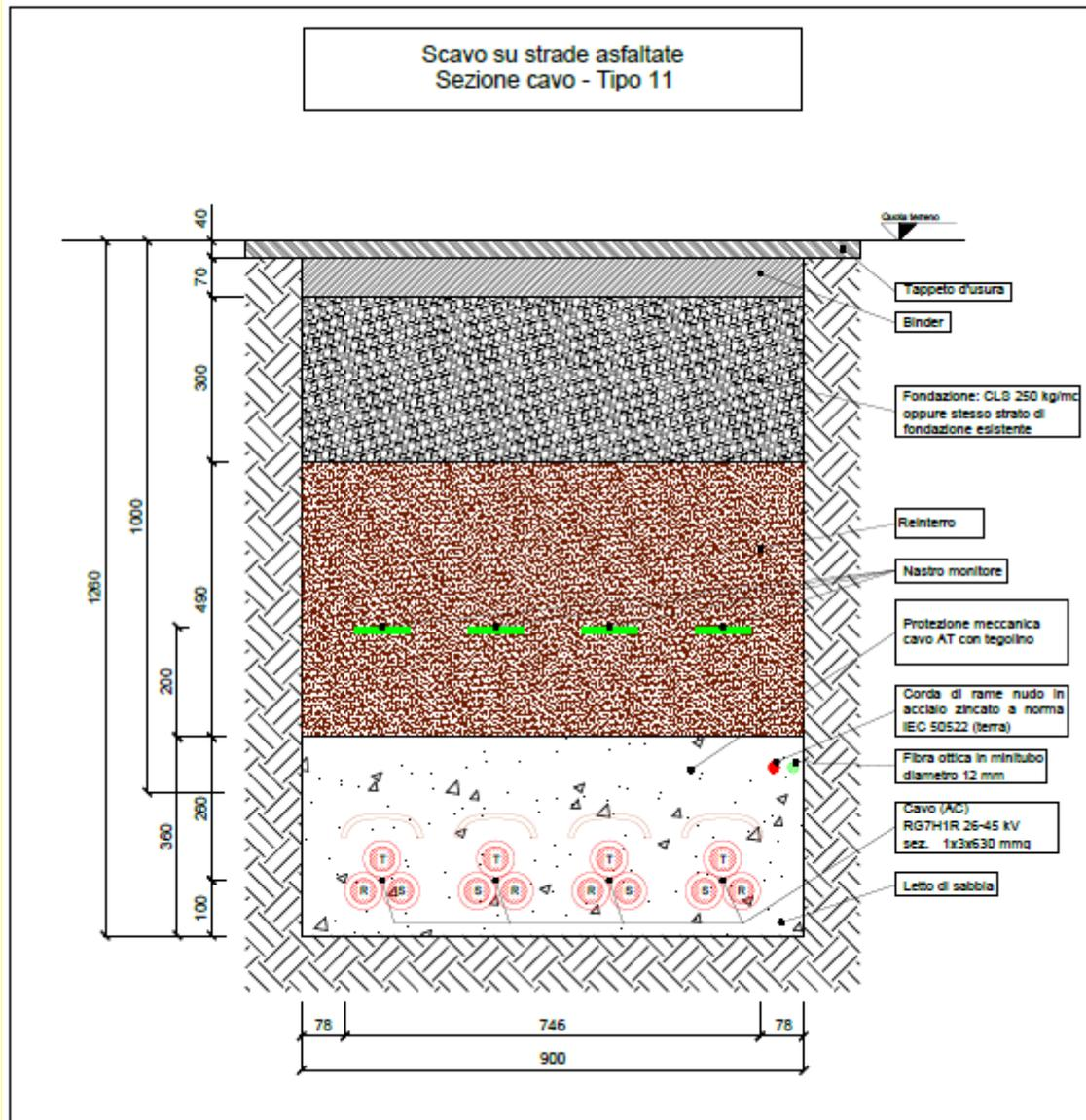
Fig. 6.5.6-6 Tipico sezione di posa dorsale di connessione con quattro cavidotti
