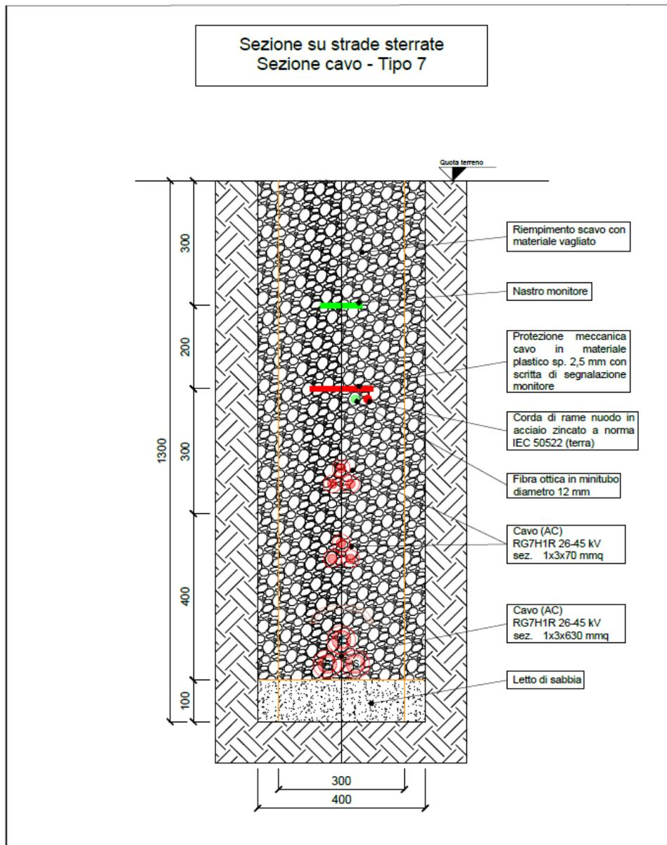
Fig. 6.5.6-3 Tipico sezione di posa con tre cavidotti
