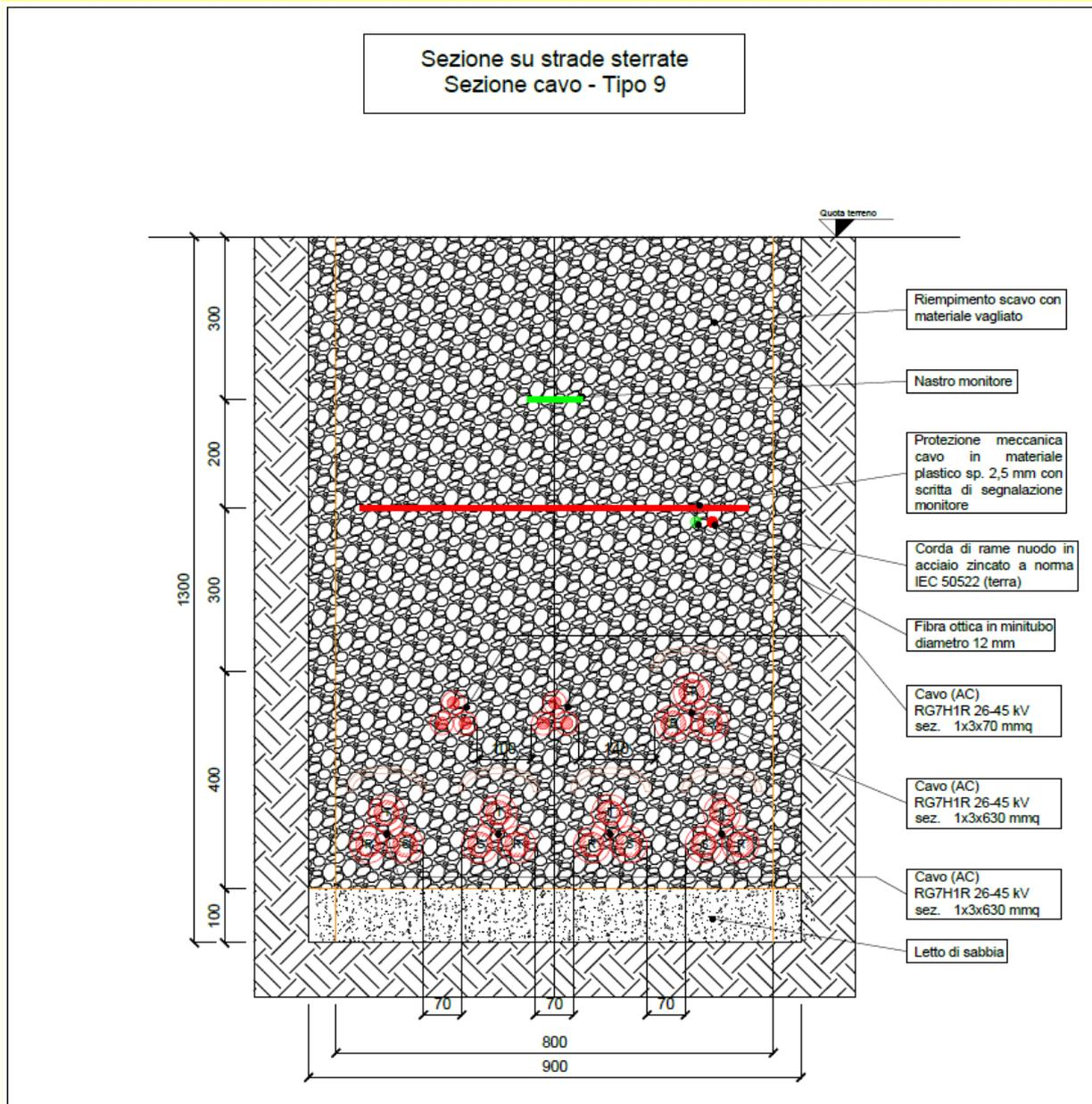
Fig. 6.5.6-5 Tipico sezione di posa con sette cavidotti
