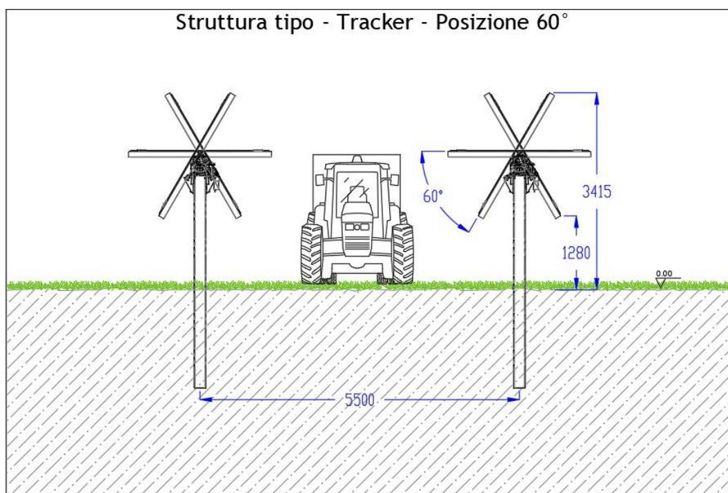
Fig. 5.4-1 Tipico struttura di supporto – Vista posizione 60°
