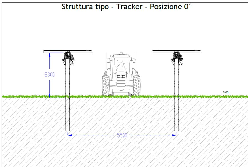
Fig. 5.4-1 Tipico struttura di supporto – Vista posizione 0°
