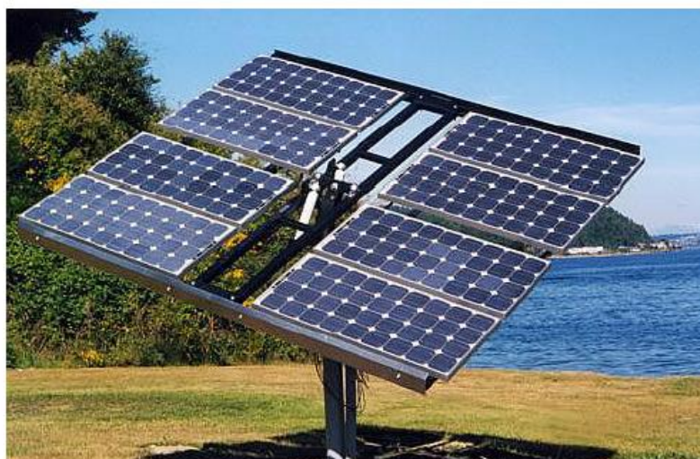
Figura 3.1-4 Inseguitori di Azimut
