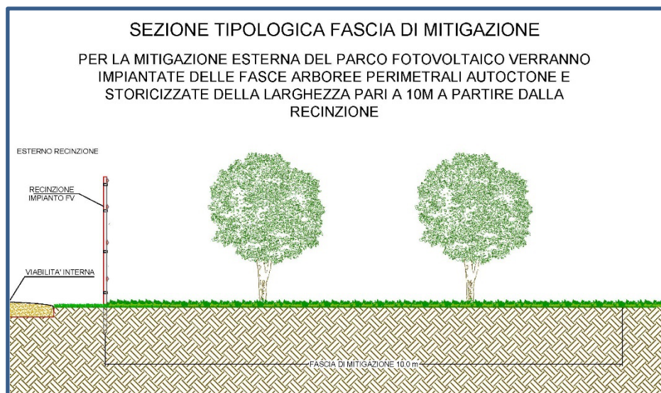
70 - Sezione tipologica fascia di mitigazione perimetrale
