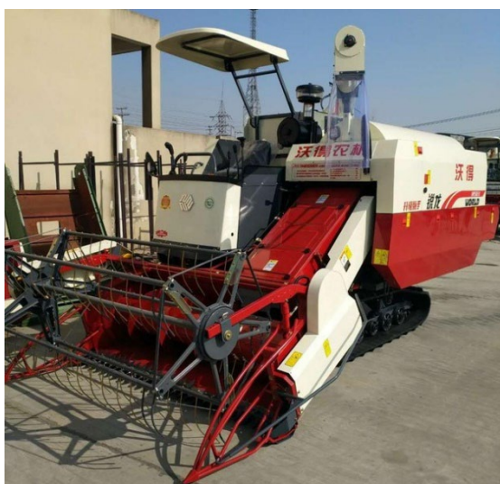
63 - Esempio di minitrebbia: la larghezza di lavoro risulta perfettamente adattabile al contesto in cui si opera
