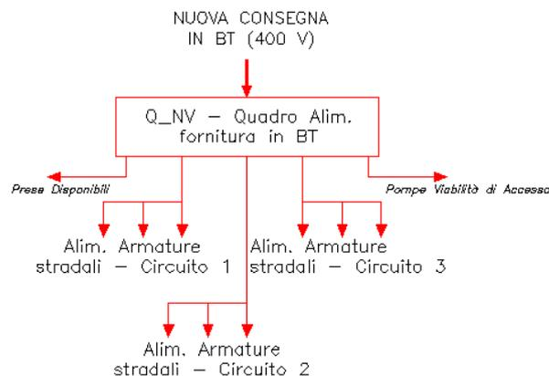
Figura 27: Schema a blocco Alimentazione Nuova Viabilità
