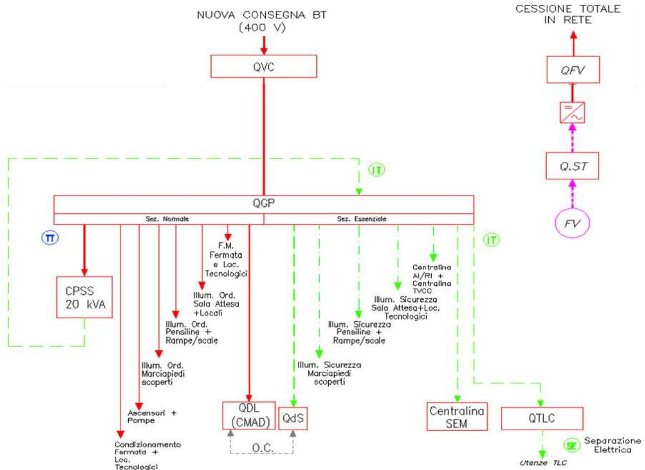
Figura 31 - Schema a blocco alimentazione LFM Fermata
