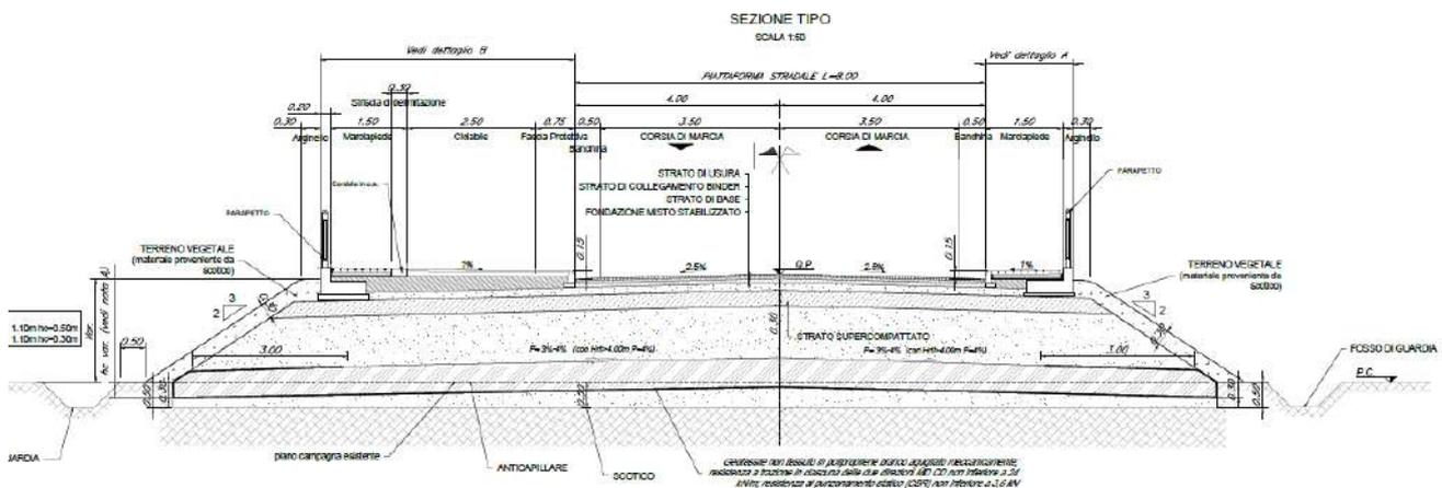
Figura 30 - Sezione tipo della viabilità di accesso alla fermata (NV01A)
