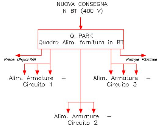
Figura 26: Schema a blocco Alimentazione LFM Parcheggio
