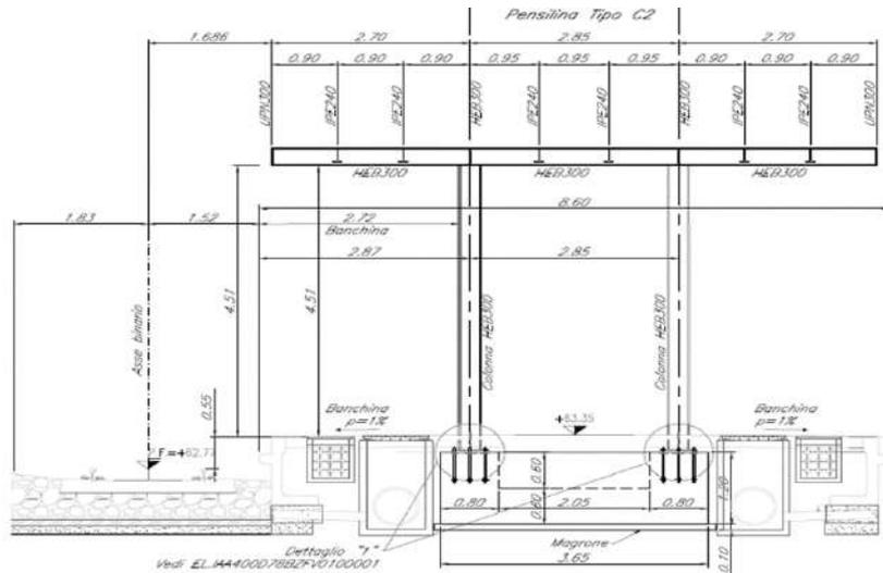
Figura 24 - Sezione trasversale della pensilina tipo C
