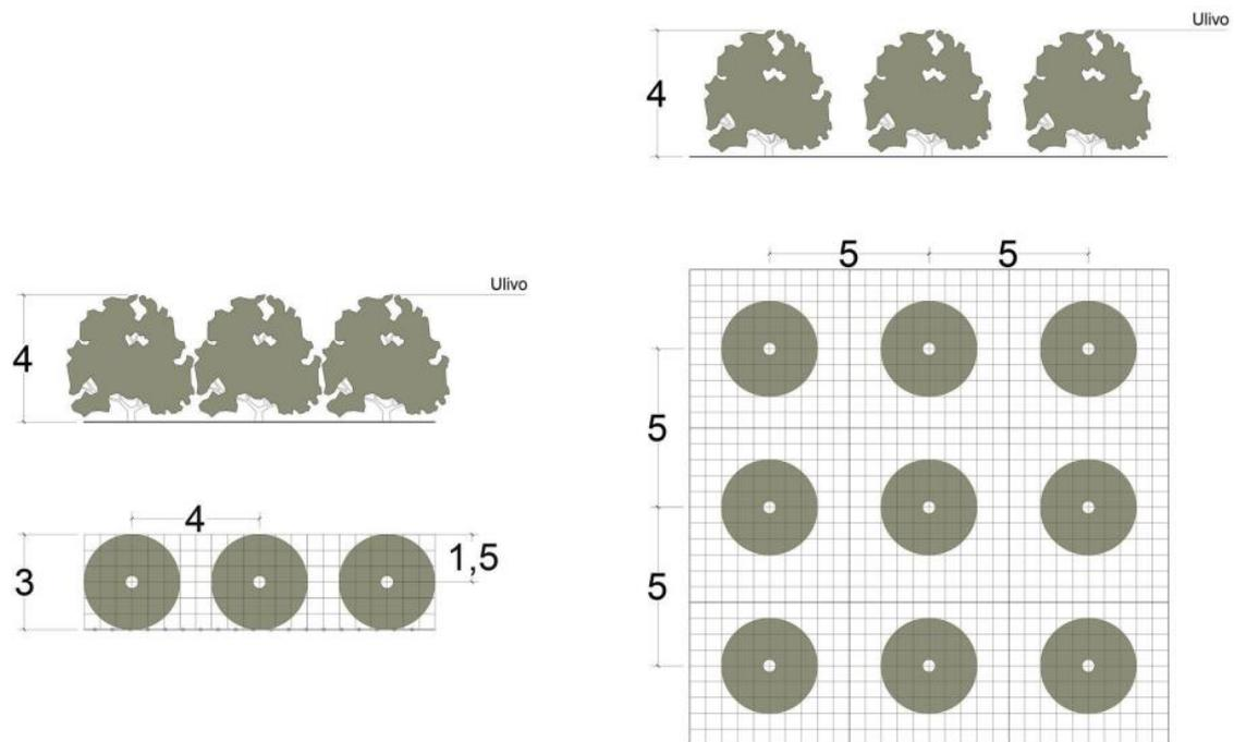
**Figura 3:** schema di impianto della fascia di mitigazione perimetrale.
