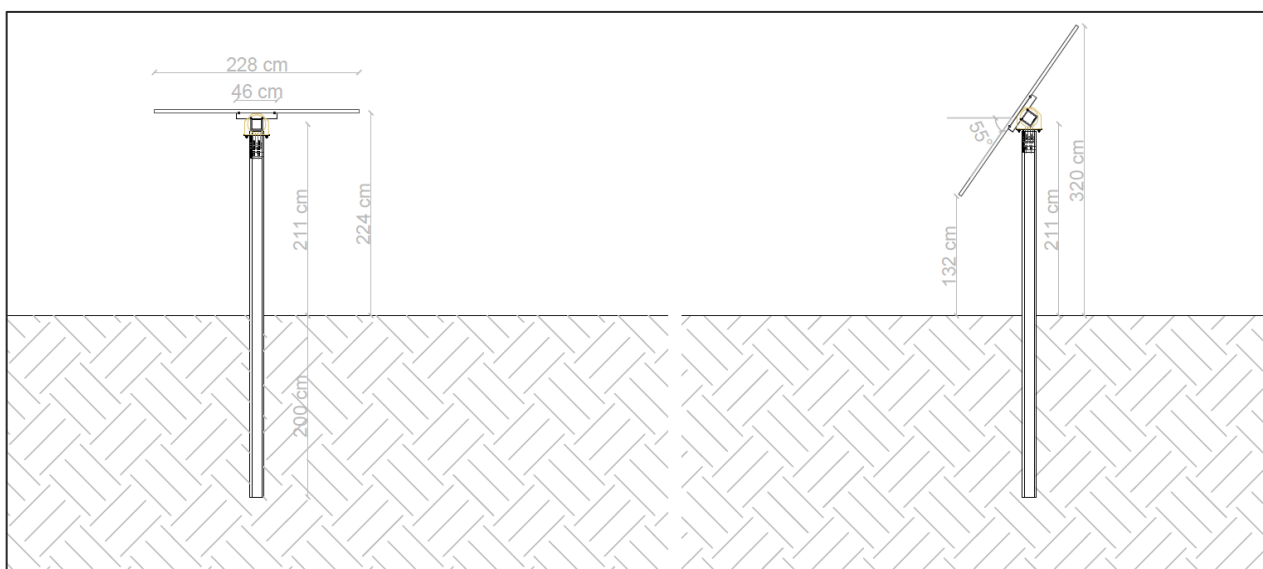
FIGURA 30 – TRACKER TIPO AD ASSE VARIABILE
