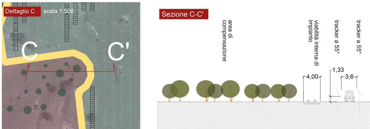
FIGURA 27 – PARTICOLARE FASCIA DI MITIGAZIONE E AREA DI COMPENSAZIONE – SEZIONE O-E DELL’IMPIANTO (ESTRATTO DALL’ELABORATO GRAFICO SIL-PDT11)
