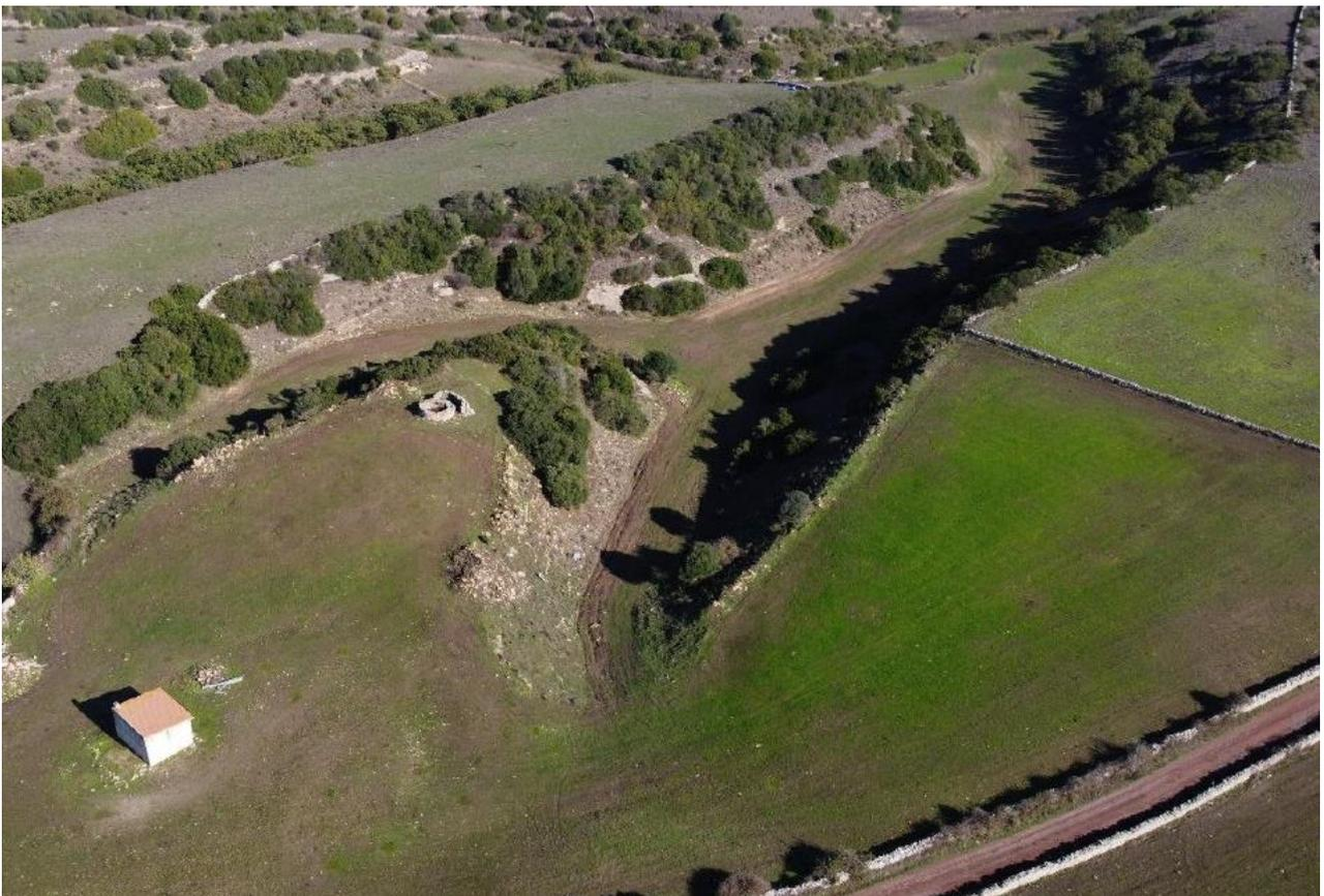
FIGURA 4 - ESEMPIO CANALI DI EROSIONE NEI PRESSI DELL'AREA DI PROGETTO
