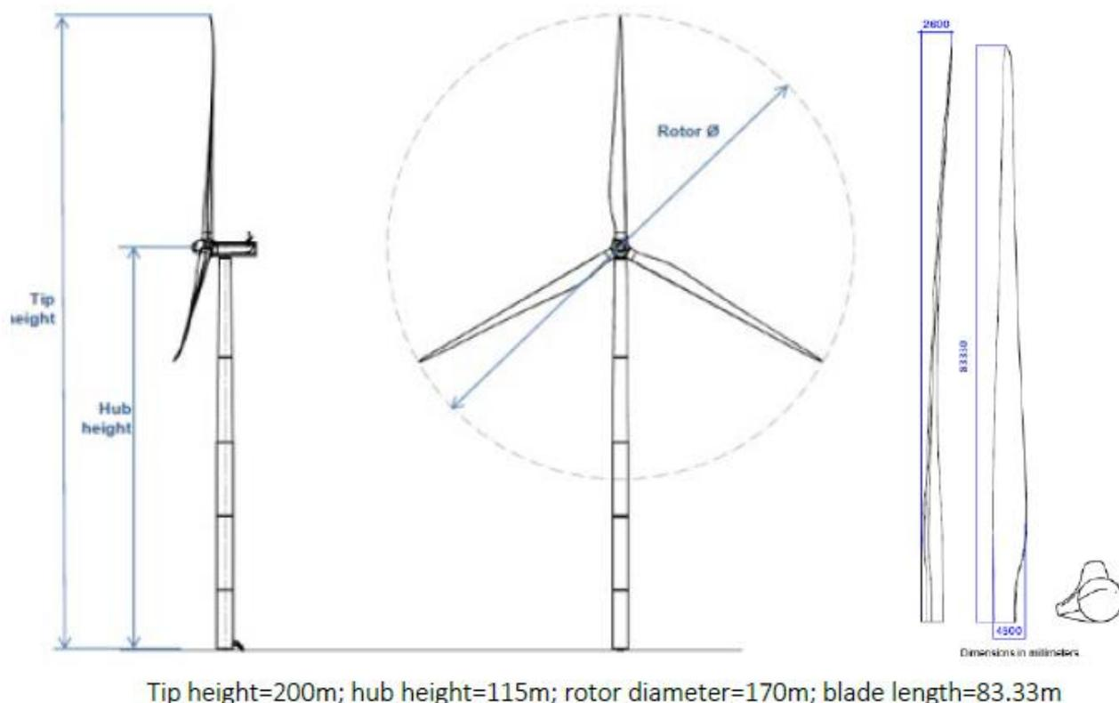
Figura 4.1: Struttura aerogeneratore
