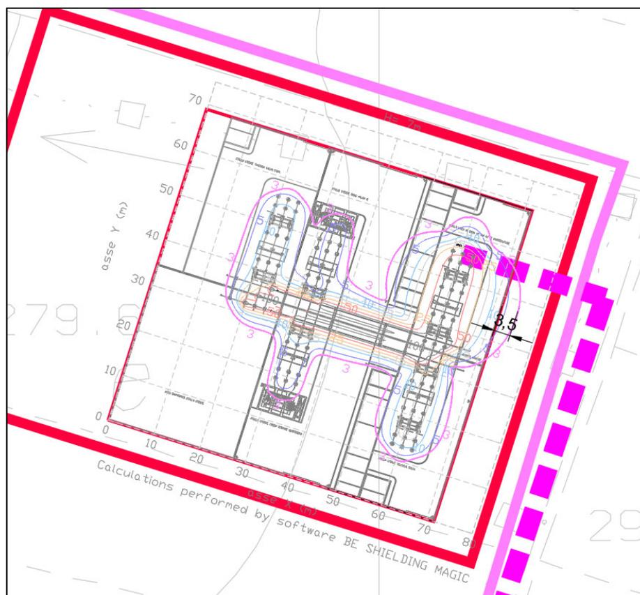
Figura 6 – Calcolo dei livelli di campo magnetico a 7 m da terra
