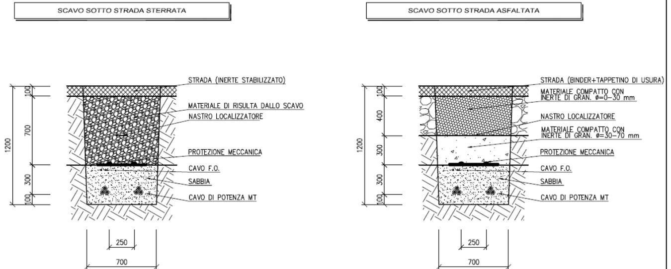
Le terminazioni dei cavi di MT saranno dotate di terminali unipolari, con isolamento estruso, mentre gli schermi dei cavi stessi saranno messi a terra in corrispondenza delle terminazioni. I giunti che si andranno ad impiegare saranno quelli unipolari dritti, con isolamento a spessore ridotto e schermo in tubo di alluminio. Infine i cavi saranno ulteriormente protetti tramite la posa, superiormente ad essi, di tegole di protezione.
