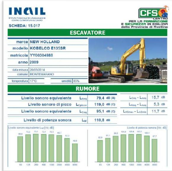
Le operazioni di cantiere vanno inquadrare in un ambito più complesso rispetto alle misurazioni dell'impianto in esercizio, in quanto più aleatorie e meno regolari, **ovvero attività di tipo temporaneo**.
