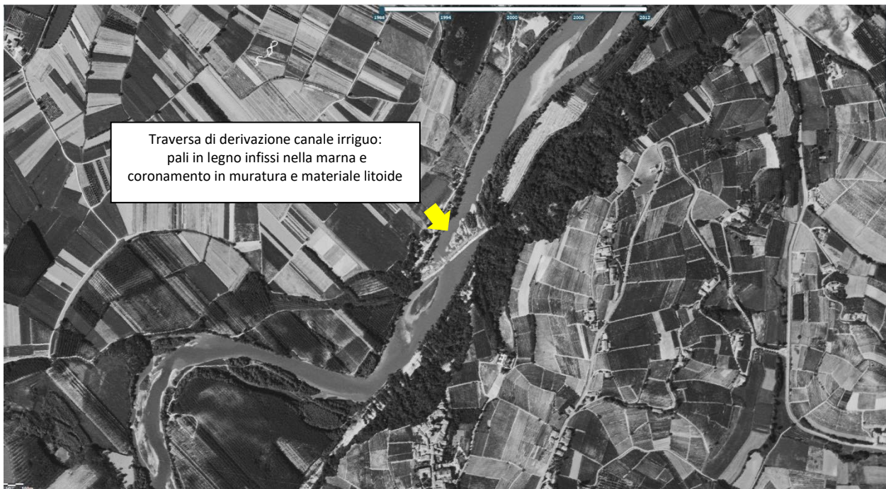
Figura 5 – Immagine ortofotografica della traversa di derivazione del Canale San Marzano – fine anni '80.
