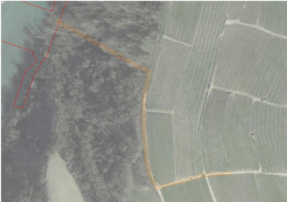
**Figura 46 - Planimetria a maggior dettaglio del tratto di linea interrata (contorno in arancione) in area boscata e su sedime di strada interpodereale**
