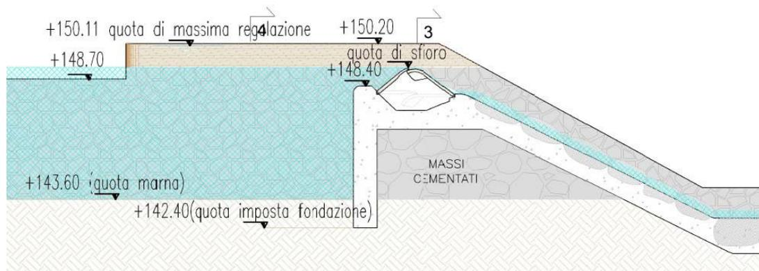
**Figura 6 - Configurazione del sistema di ritenuta a doppia falda aperto**
