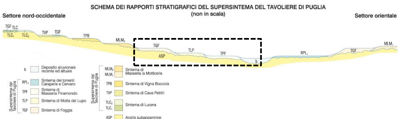
Figura 2 – Schema dei rapporti stratigrafici del settore settentrionale del F°408 "Foggia" in cui ricade l'area di studio, indicata nel riquadro nero. Fonte: www.isprambiente.gov.it
