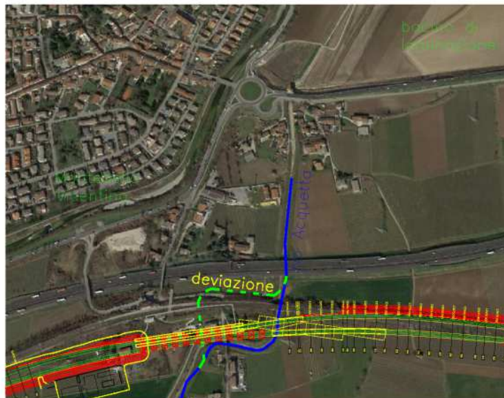
Figura 5-8 - Attraversamento e deviazione Rio Acquetta.
