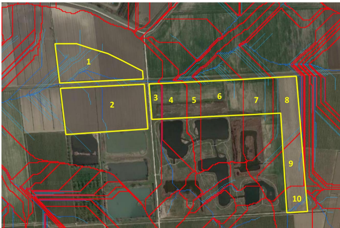
Figura 30: Delimitazione bacini scolanti e codifica (giallo), reticolo di drenaggio esterno ed interno alle sezioni di progetto (blu) e limiti bacini idrografici (rosso).
