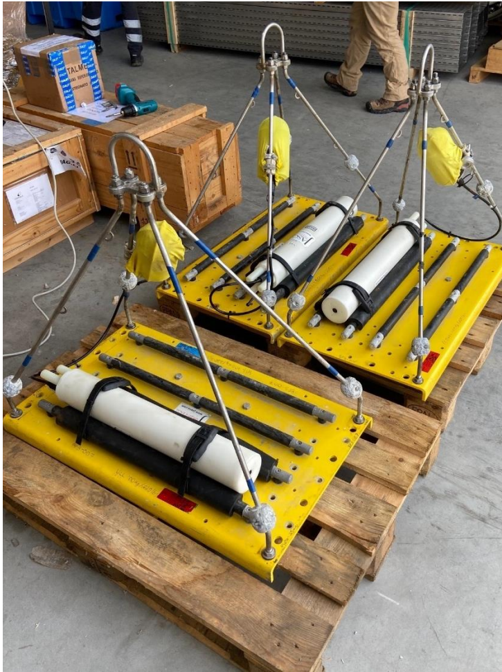
Figura 4. Registratori acustici AMAR G4 (tubi bianchi) montati su piastra metallica usati per misurare il rumore sottomarino durante l'allibo presso l'FSRU Toscana. L'idrofono è fissato a circa un metro dalla piastra metallica sulla struttura tetraedrale e coperto da un tessuto di lycra gialla.
