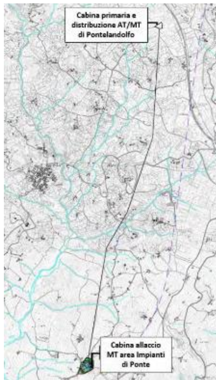
Figura 18 – Tracciato del collegamento alla rete elettrica nazionale dell'impianto idroelettrico (linea nera)
