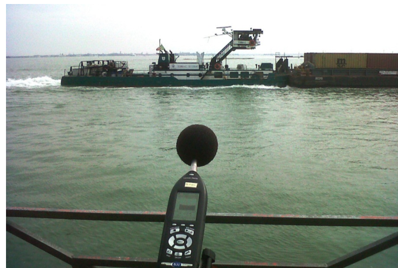
Figura 20-2 Lo spintore Tobia C nel corso delle misurazioni fonometriche.
