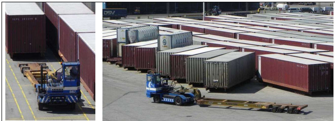
Figura 9.4. Tractor e trailer per la movimentazione dei container
